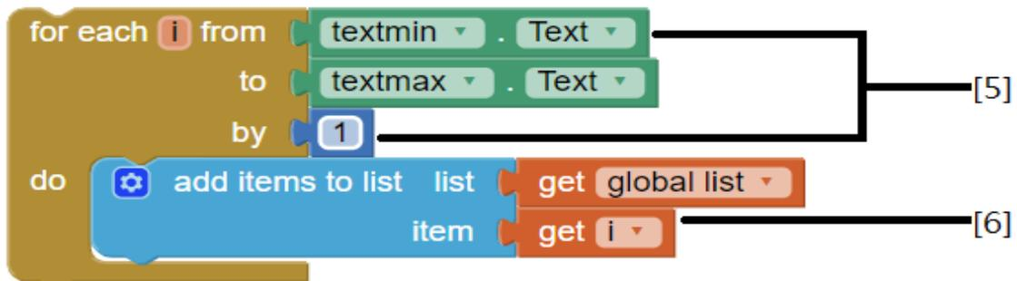
[ 5 ] 此步驟為執行迴圈動作，先設定迴圈變數  $i$ ，迴圈的起點為文字輸入框 `textmin` 的數值，也就是  $i$  的初始數值，之後，以每次累加 1 的方式進行迴圈動作，直到  $i$  大於迴圈的終點，也就是文字輸入框 `textmax` 的數值，此時，迴圈才停止動作。
